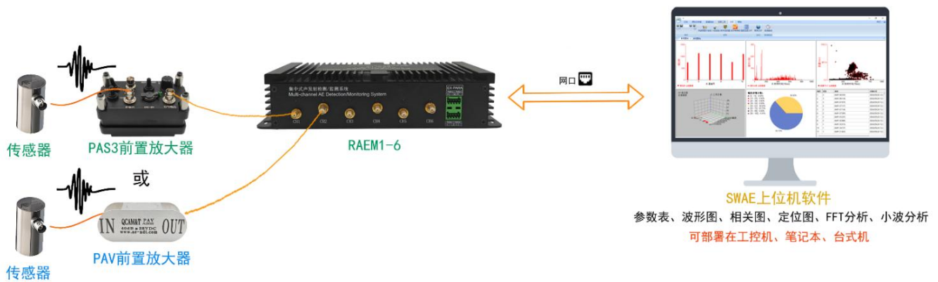
无内置前置放大器的传感器连接
